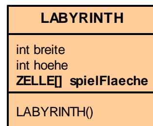
Abbildung 4: Erweitertes Klassendiagramm mit der Deklaration des Feldes spielFlaeche als Umsetzung der Beziehung aus Abbildung 1
