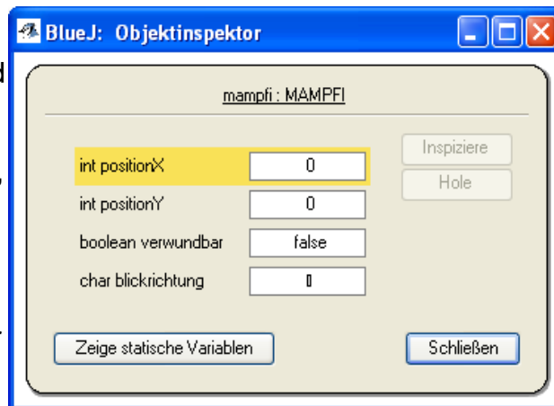
Abbildung 5: Attributwerte von mampfi im Objektinspektor – der Wert false des Attributs verwundbar passt nicht zum Startzustand von mampfi , der Wert des Attributs blickrichtung ist unsinnig
